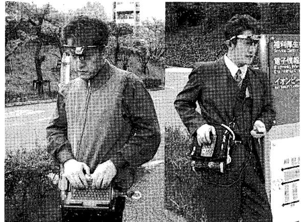
図1 ウェアラブルコンピューティングの典型スタイル。頭にHMD、腰にパソコン、右の写真では手にポインティングデバイスを持っている
