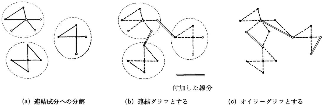
図 3 空送り線分の付加によるオイラーグラフへの変形
