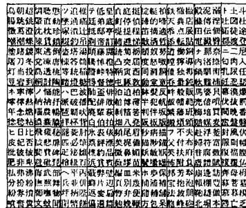
図1 紙テープ出力・キーボード(TORAY 8511)盤面文字種と文字配列
