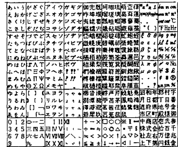
図1 紙テープ出力・キーボード(TORAY 8511)盤面文字種と文字配列
