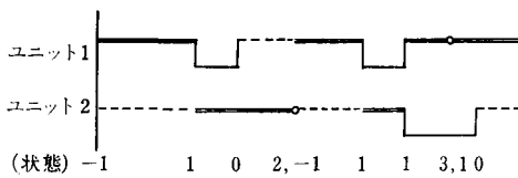
図2 システムの挙動と状態 —動作, -予防保全, ...待機, ○取替え
