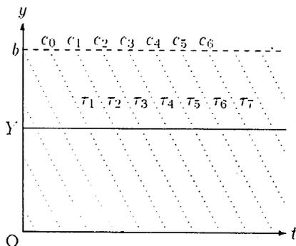
図 3: 位置  $Y$  を通過する車両  $c_0, c_1, c_2, \dots$
