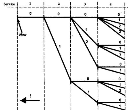
図 3: エレベータがサービスを終了している場合 (枝の上部の数字は  $\Delta$  時間の呼びの数、時間軸は逆向き)
