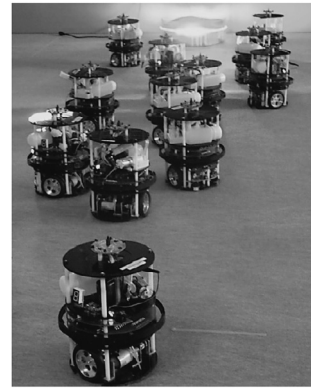
図2 群ロボットシステム ARGOS の集団採餌 奥が餌場で、手前が巣。
