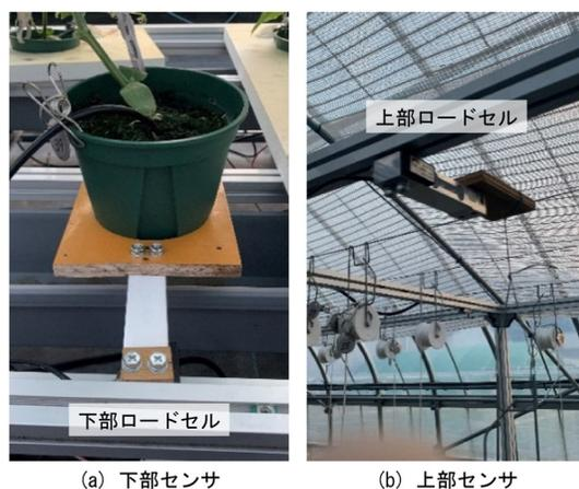
図1 ロードセルを用いた植物体重量計測装置
