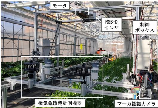
図 3 植物フェノタイピングシステムの構成
