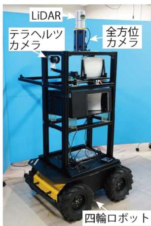
図3 移動検問ロボットの外観
