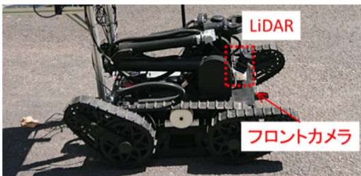
図 15 LiDAR を搭載したクローラ型移動ロボット
