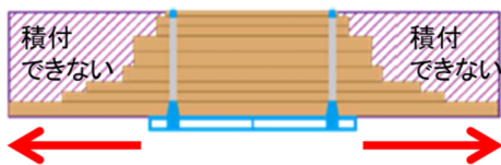
図7 長尺物の積み付け
