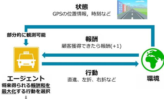
図2 ルート推薦のための強化学習の概要
