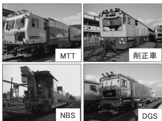
図9 軌道保守に用いられる主要な機械
