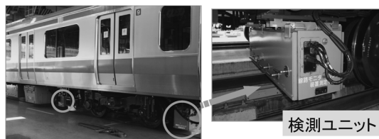
図 7 営業車に設置された軌道検測装置
