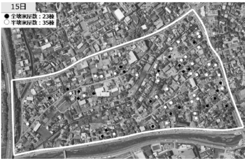
図 5 4月15日（本震前）の被害状況（目視判読）
