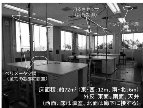
図 21 オフィスビルの模擬実験
