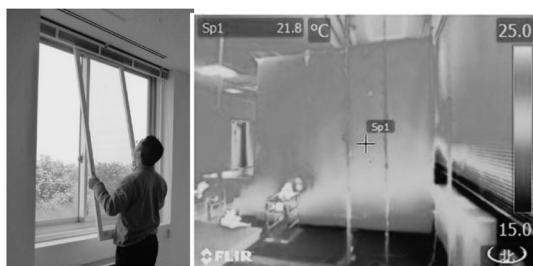
図 22 内窓設置による室内環境の改善効果の検証
