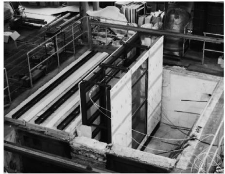
図7 建築研究所耐火炉に設置したダブルスキン実験装置
