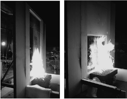
図 10 ガラスの大きさが脱落時間に及ぼす影響の実験
