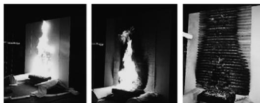
図 23 木質壁の仕上げによる燃焼性状の実験
