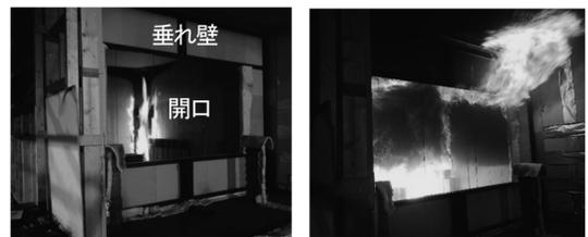
図 18 実大火災実験の様子 (左:着火後, 右:FO 発生時点)
