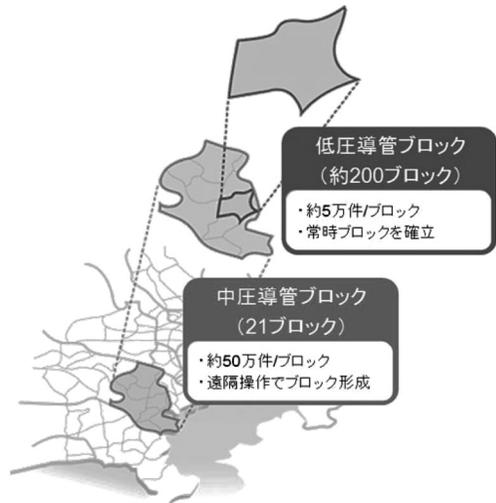
図 1 ブロックのイメージ (東京ガス HP より)
