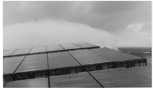
図5 コンテナ船での船首海水打ち込み状況
