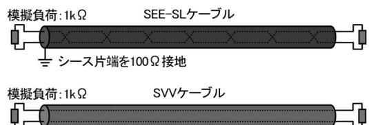
図2 地上敷設信号ケーブルの設定条件
