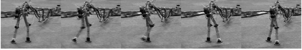
図2 学習によって獲得された制御則によって実現されたロボットの歩行運動。
