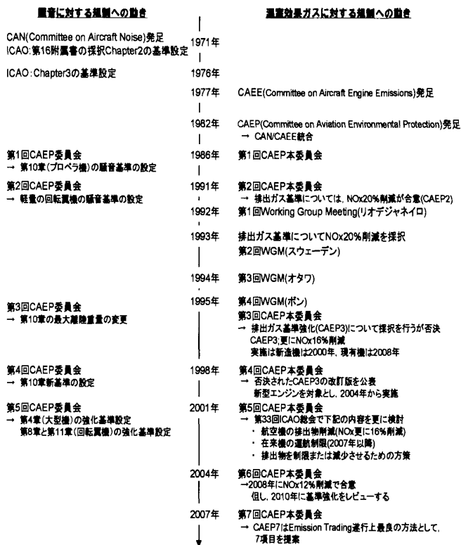
図3 ICAOによる騒音および温室効果ガスの規制
