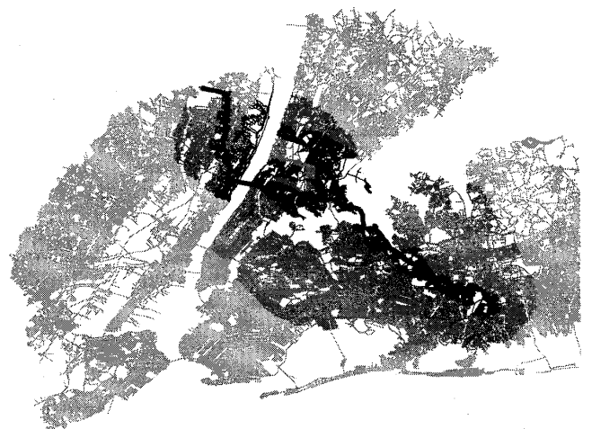
図1 ダイクストラ法とA*法の探索範囲
